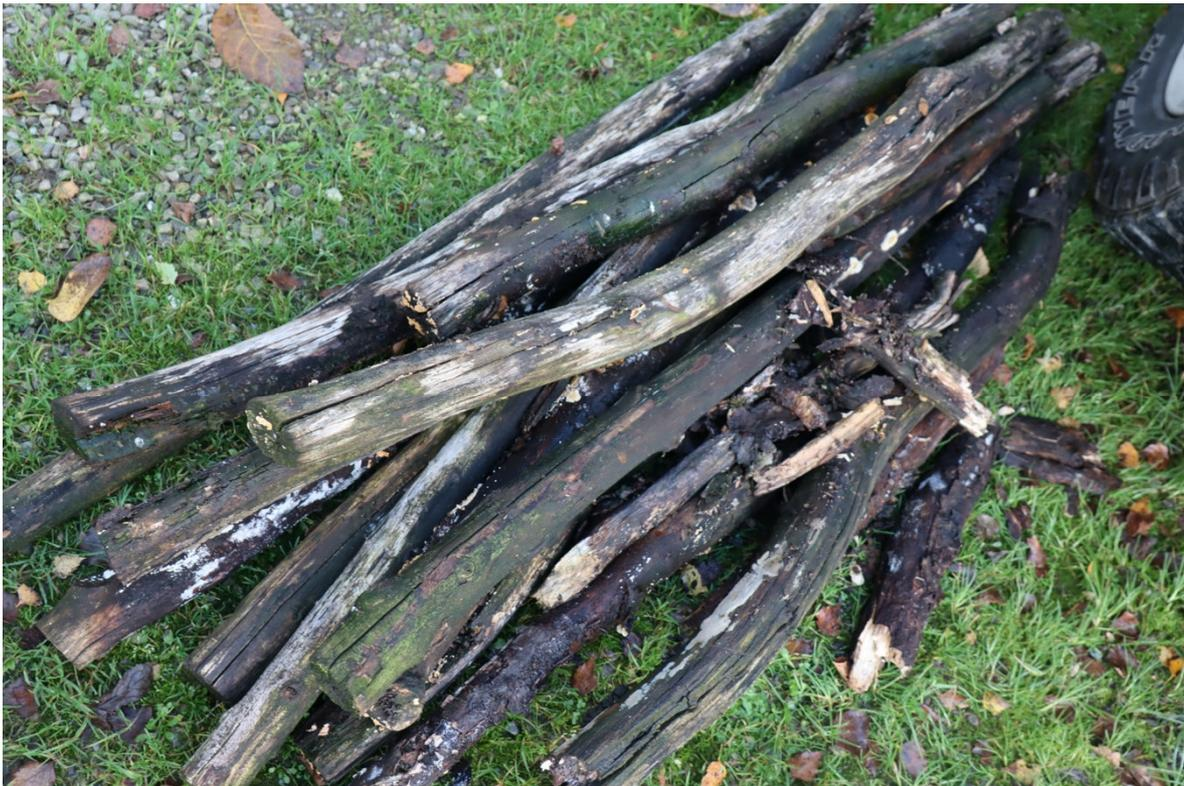
Das Holz ist stark verfault, was zu einer potentiellen Gefährdung führt. Obschon Hartholz verwendet wurde, ist das Holz nach den sieben Jahren so verfault, dass es zum Teil bereits brüchig und morsch ist.
